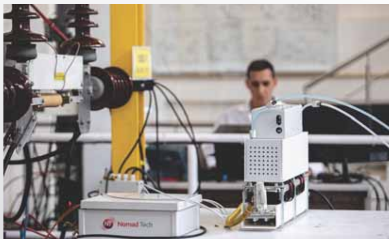
Power Modul für Lokbaureihe 185.2 im Labortest.
