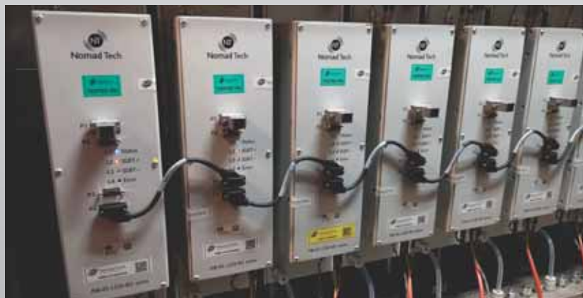
In das Triebfahrzeug 185-281 eingebaute Power Module.
